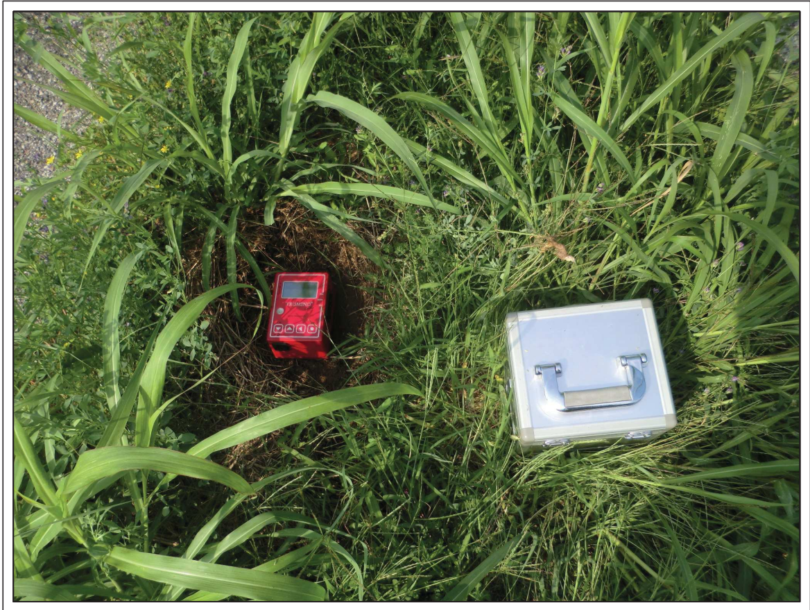
Fig. 5 - Esecuzione dell'indagine sismica con stazione singola HVSR_1 (06/09/2018)
