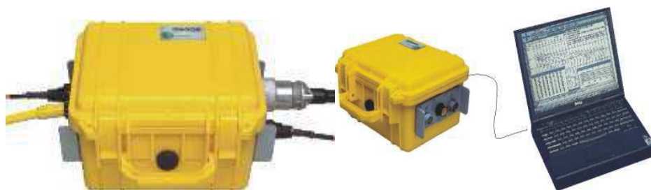
Figura 1: Sismografo “Geode” collegato al pc
