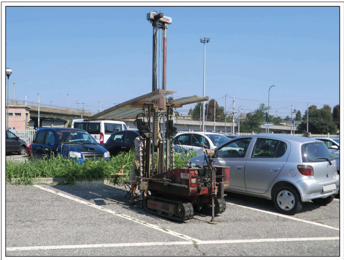
Fig. 3 - Esecuzione della prova penetrometrica dinamica SCPT3 (05/09/2018)
