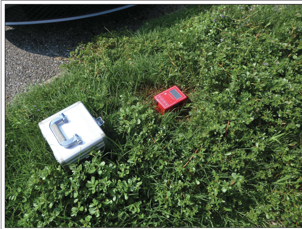
Fig. 7 - Esecuzione dell'indagine sismica con stazione singola HVSR_3 (06/09/2018)
