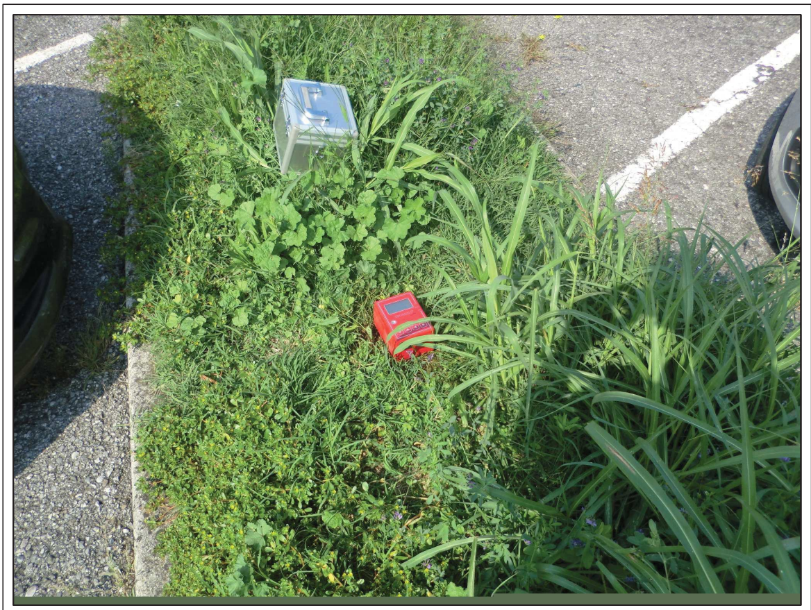
Fig. 6 - Esecuzione dell'indagine sismica con stazione singola HVSR_2 (06/09/2018)
