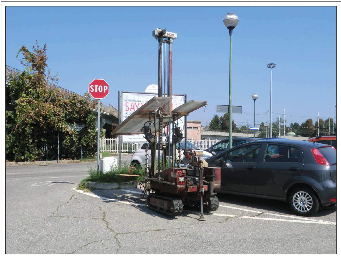
Fig. 4 - Esecuzione della prova penetrometrica dinamica SCPT4 (05/09/2018)
